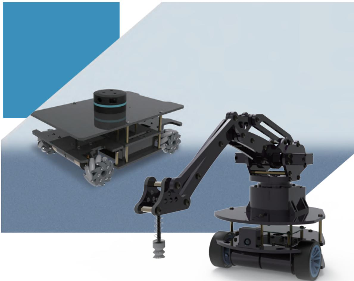
本教育机器人平台可以实现物体识别、自动抓取、机器人定位及导航、语音识别、动作识别和人脸识别等功能，支持python、C++和图形化语言编程，可以根据需求对各功能模块进行配置，便于二次开发。
